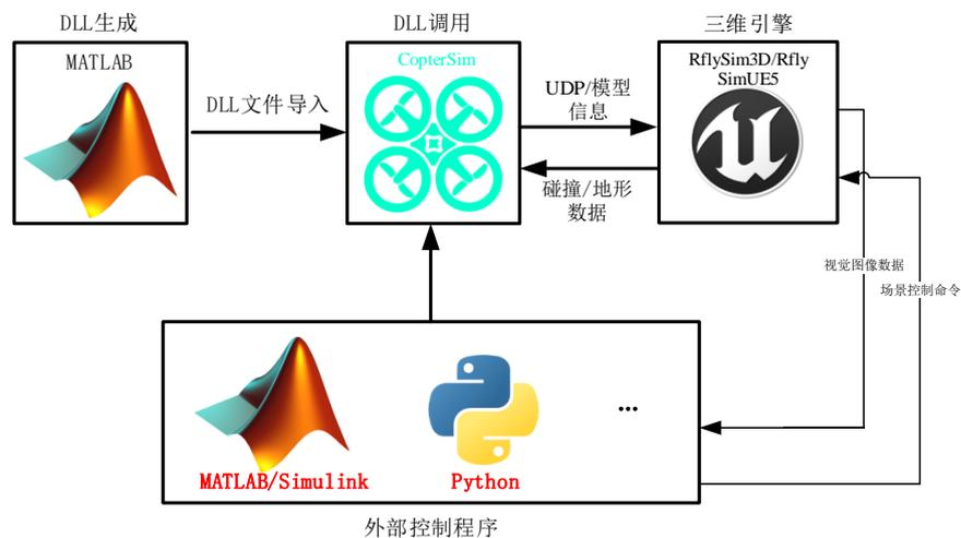
三维场景建模仿真的实现流程可以分为三维场景的开发及其与仿真平台的集成，本平台用于实现三维仿真的主要工具 RflySim3D 是基于 UE4 开发的可交互 3D 程序，它集成了无人系统仿真所需的大部分场景元素，并提供了相应的交互接口，且这些交互接口除了内置的控制台命令和快捷键外，还包括外部程序调用的方式，其中 Python 接口库如下 [UE4CtrlAPI.py](#)、[UEMapServe.py](#)
